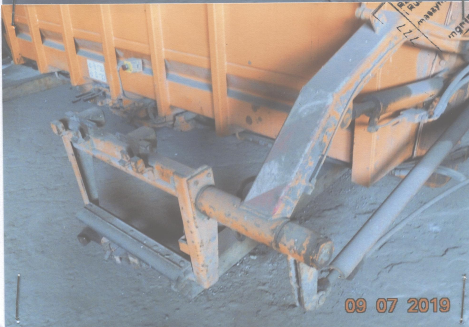
Zbliżenie na urządzenie do rozładunku bocznego .
