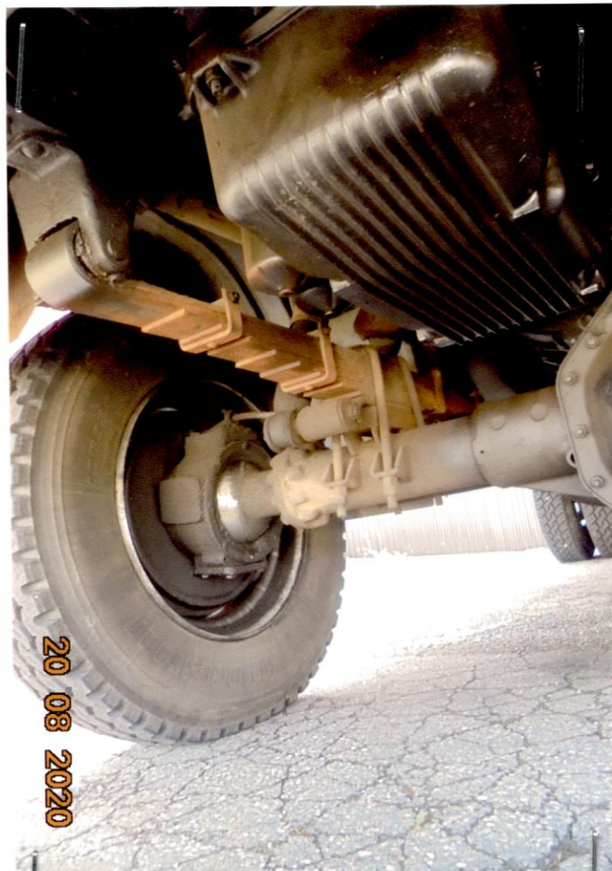
(20) Ujęcie napędu na przednią oś (4 x 4 ). Widoczna misa olejowa silnika .
