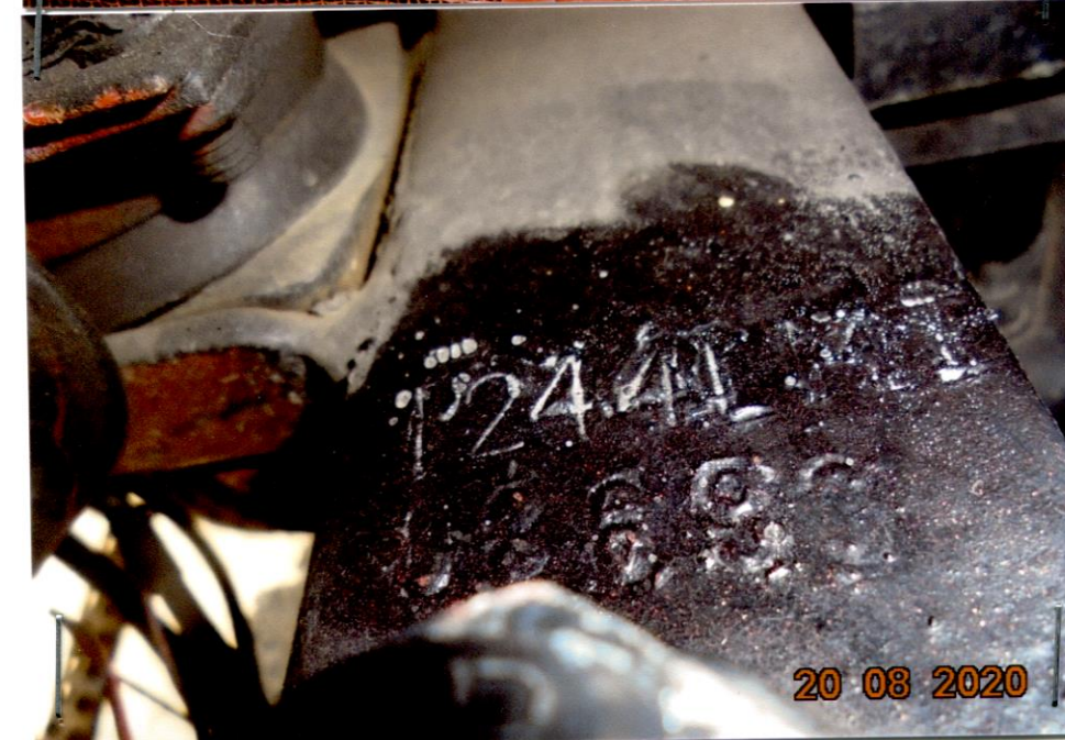
(3) Nr VIN wybity na ramie samochodu - prawa przednia strona ramy samochodu – VIN 12 znakowy : P244LM108693
